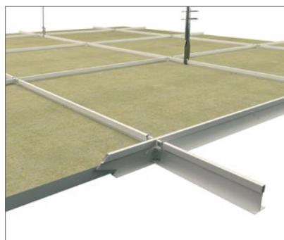
Основные направляющие высотой 38 мм и поперечные профили с повышенной коррозионной стойкостью, изготовленные из предварительно окрашенной, оцинкованной горячим цинкованием стали Z 275 с дополнительной защитой, обеспечивающей повышенную коррозионную стойкость, состоящей из 275 г цинка на м<sup>2</sup>.
