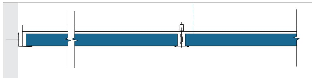
Кромка A - отделка периметра с помощью пристенного угла.
