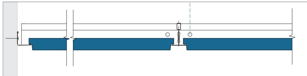
Кромка E - отделка периметра с помощью пристенного угла.
